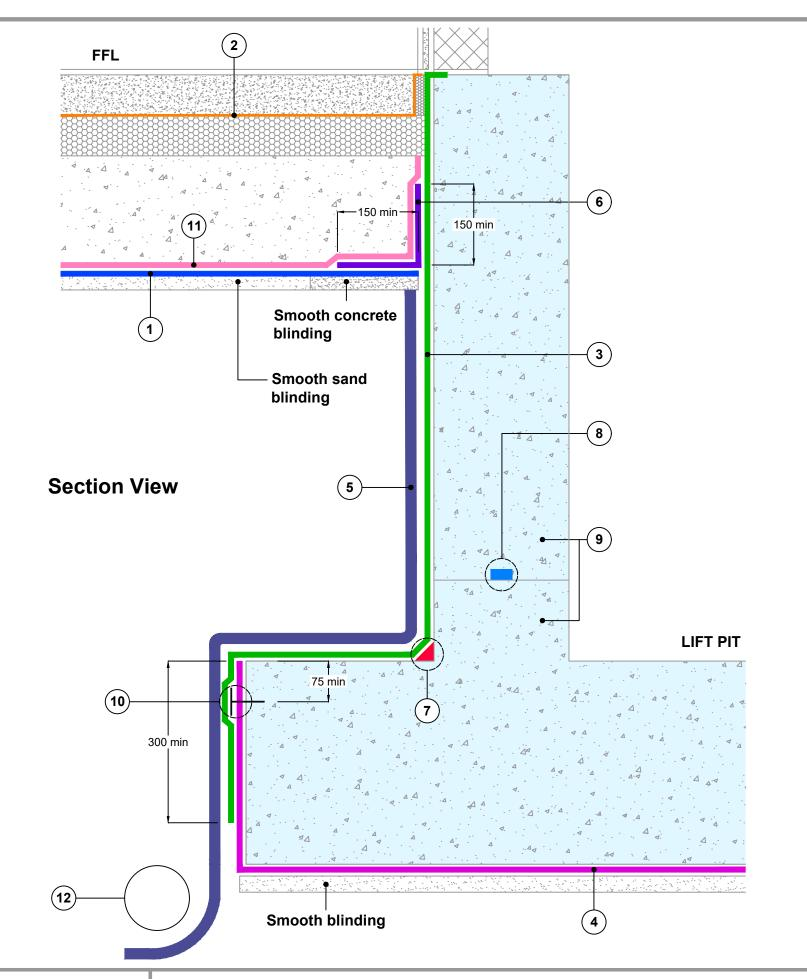
**BARRIER BELOW SLAB** CAST IN SITU RC GROUND BEARING SLAB AT **LIFT PIT**
